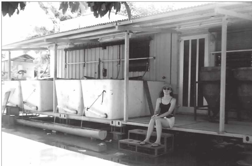
Foto 8 - Laboratório móvel provido de incubadoras para ovos livres de peixes, conhecido por Fish-Com e importado da Hungria.
