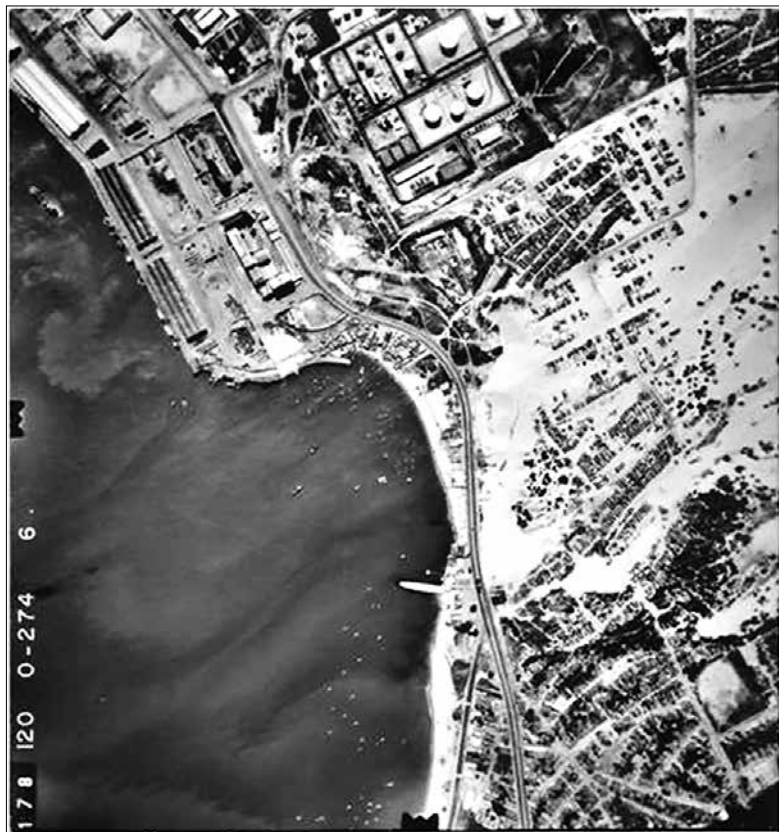
Figura 21 - Fotografia aérea de 1972, mostrando o sedimento eólico transportado das dunas do Mucuripe para o fundo da enseada, na altura do porto. Parte da areia foi retirada para construção do estacionamento do porto e acesso para a Praia do Futuro. Fonte: Leal (2009).
